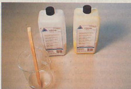
Das Basismaterial: Silikon-Kautschuk, der im Verhältnis 1:1 mit Härter angemischt wird.
